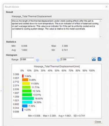
12. ábra. A hőmérséklet eltérés általi deformáció mértéke.
