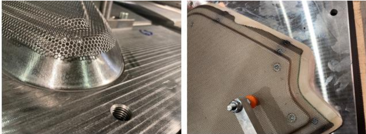
5. ábra. Alkatrész a mérőkészülékre helyezve, majd leszorítva.
