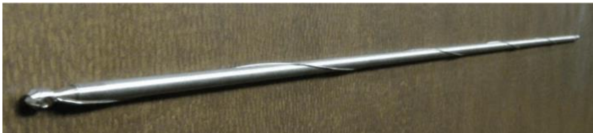
2. ábra. Dróttal spirálisan betekert üzemanyagpálcák, változó menetemelkedéssel [12].
