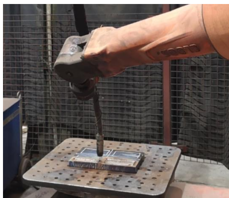
2. ábra. A hegesztőrobot és a munkadarab elrendezése.
