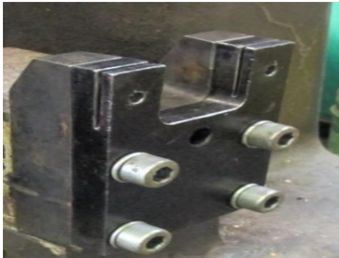
3. ábra. Az ütővizsgálathoz kialakított új ülék.
