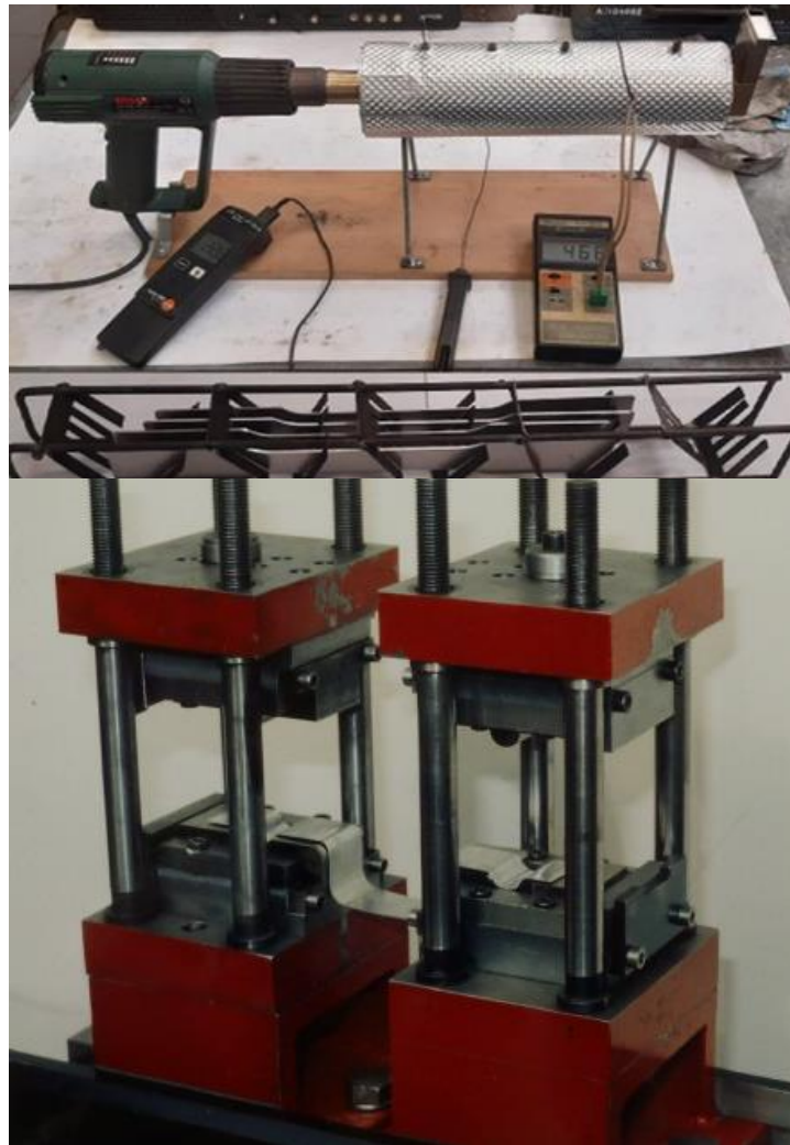
4. ábra. Oldó izzítás kivitelezésére szolgáló berendezés és az alakító szerszám.
