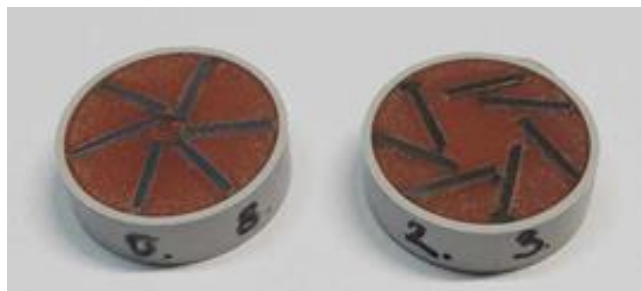
5. ábra. A beágyazott mikroszerkezet vizsgálatra előkészített huzalok
