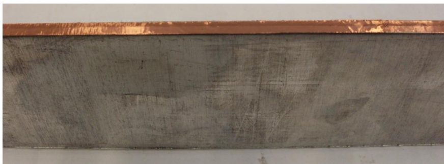
M4.3. ábra. Réz fóliás kísérletekhez előkészített lemez
