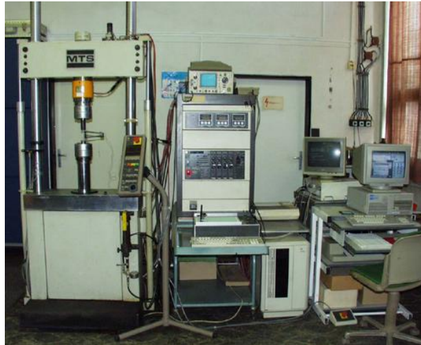
4.2. ábra. MTS 810.23 típusú elektro-hidraulikus anyagvizsgáló berendezés
