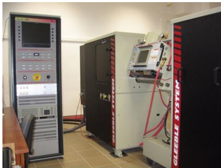
3.17. ábra. A Gleeble 3500 termo-mechanikus szimulátor a Miskolci Egyetem Anyagszerkezet-tani és Anyagtechnológiai Intézetében
