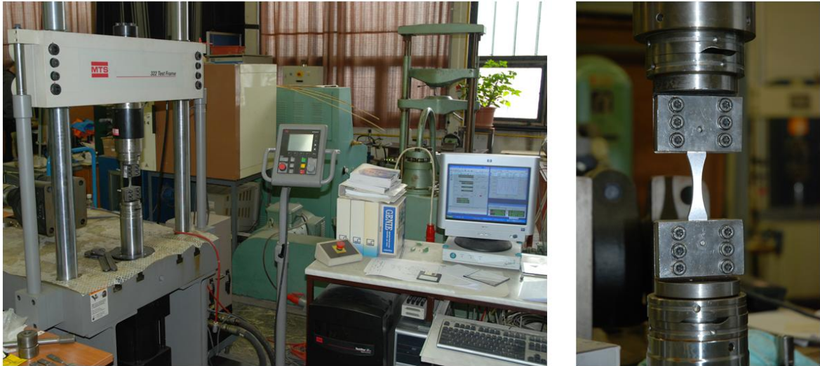
4.13. ábra. Nagyciklusú fárasztóvizsgálat az MTS 322 univerzális anyagvizsgáló rendszeren
