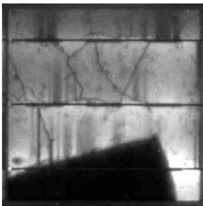
59. ábra. a) Széles törés által okozott, teljesen levált cellatöredék; b) példák ujszerű hibákra
