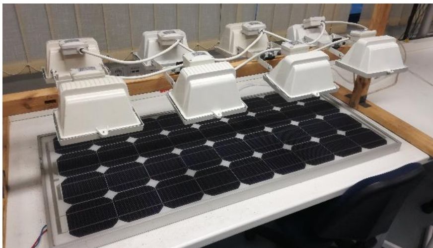
25. ábra. A napszimulátor által megvilágított napelem panel
