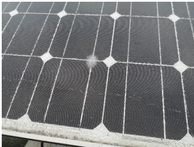
38. ábra. Jégcső okozta sérülés a modul üveghorításán
