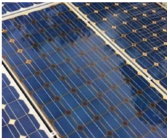
39. ábra. Elszineződött napelem modul
