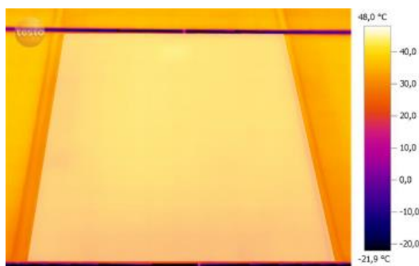
33. ábra. Egy működésképtelen modul hőkamerás képe
