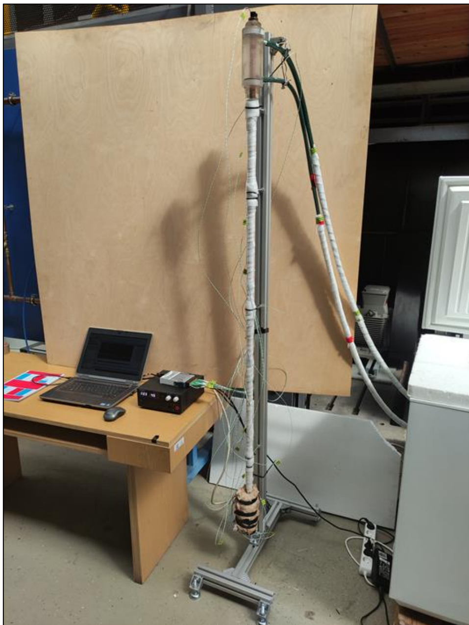
5. ábra. Az összeállított hőcső-egység és a mérőrendszer
