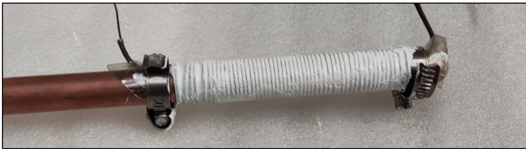
3. ábra. Az elpárolgató szakaszon elhelyezett, hővezető pasztával bekent ellenálláshuzal
