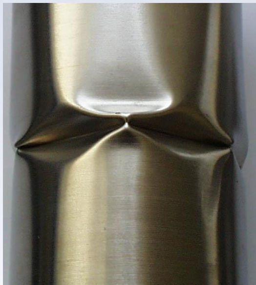
Axiálisan szabadon nyomott cső ( L/D=5.78 )
