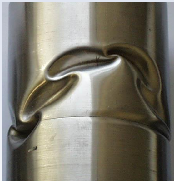
Kívülről támasztott axiálisan nyomott cső (száraz hüvelyben) L/D=5.81
