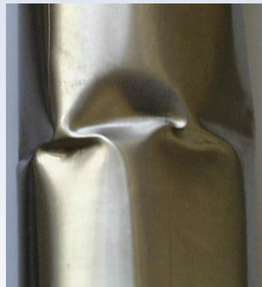
Kívülről támasztott axiálisan nyomott cső (zsírozott hüvelyben) L/D=5.77
