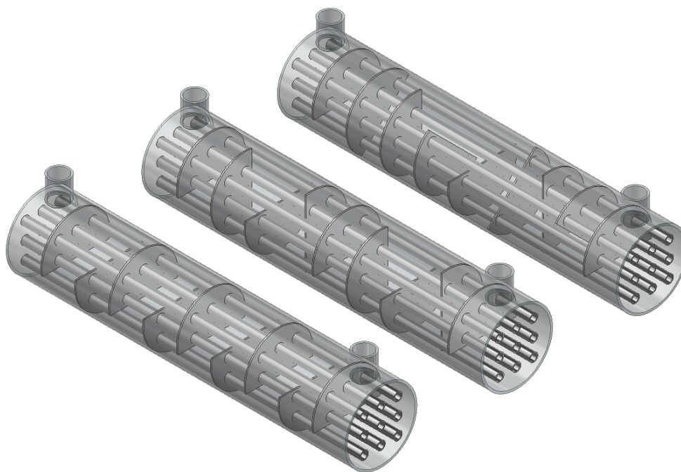
4.6. ábra. Hőátadási tényező és nyomásveszteség számításához használt modellek, állandó terelőlemez távolsággal
