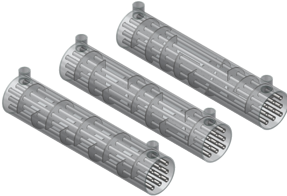
4.6. ábra. Hőátadási tényező és nyomásvesztés számításához használt modellek, állandó terelőlemez távolsággal
