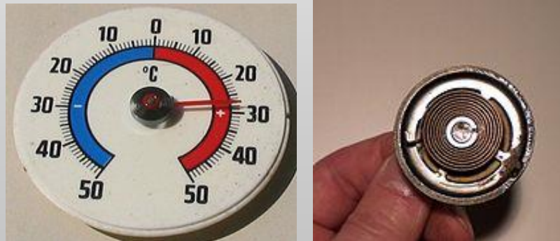
62. ábra: Hőmérséklet mérési példa spirál alakú bimetállal (Wikipedia)
