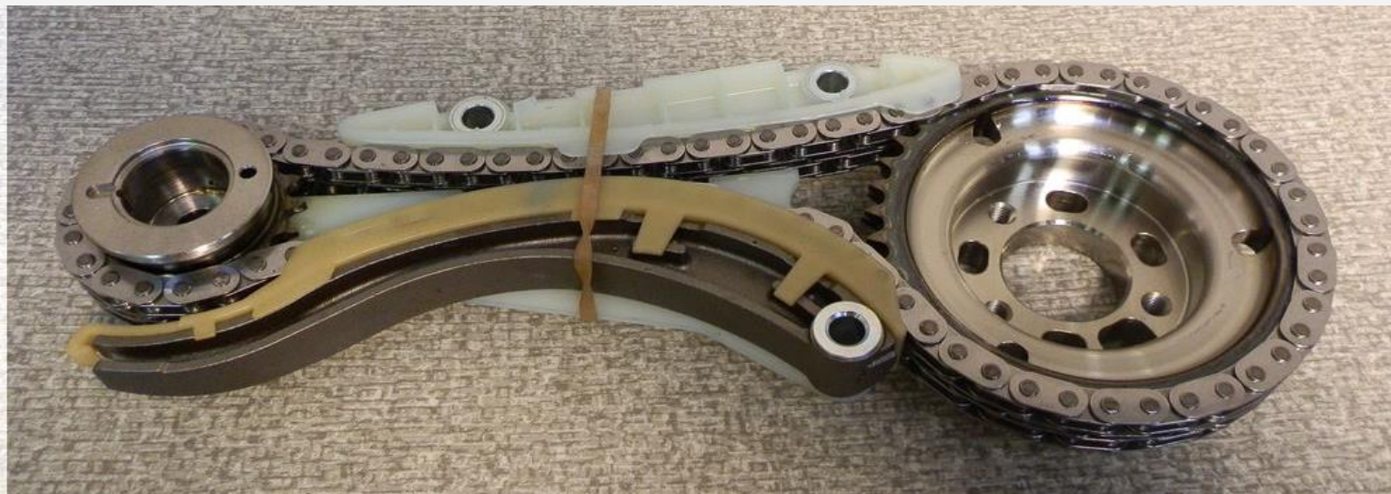
25.c ábra: Görgős vezérmű lánc – Ford Focus, https://www.google.hu
