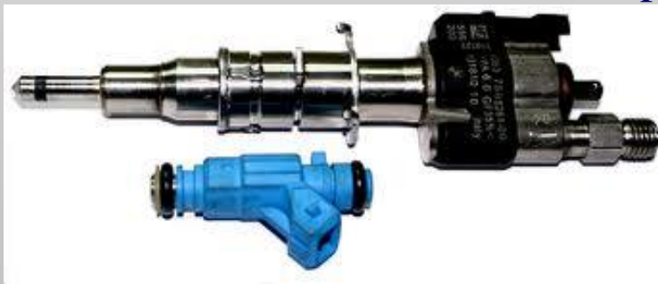
59. a ábra: BMW piezo befecskendező
