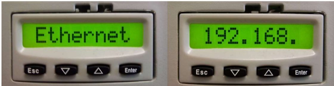
12. ábra: IP-cím kiolvasása a PLC hardveregységen
