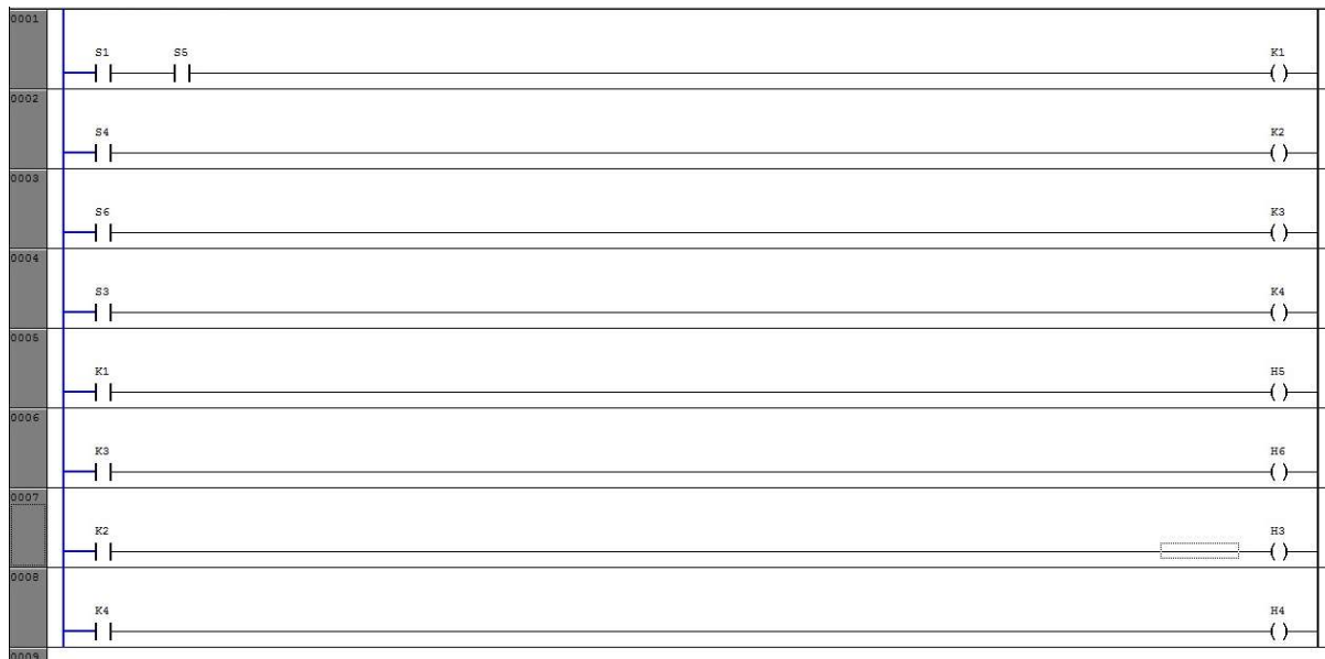
46. ábra: Elektropneumatika 16. feladatának megoldása LD programnyelven
