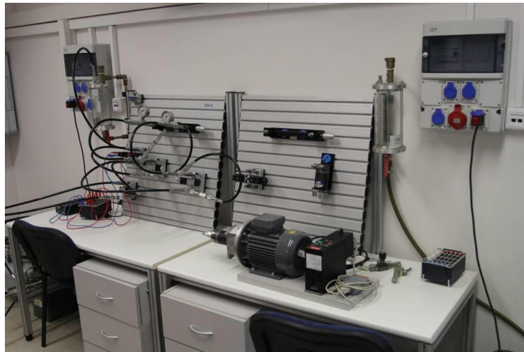
5. ábra Hidraulika gyakorló-készletes munkahelyek
