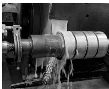
Keménysztergálás: CNC eszterga Optiturn S600 Köszörülés: Egyetemes köszörűgép KE 250-04 Topográfia mérés: AltiSurf 520
