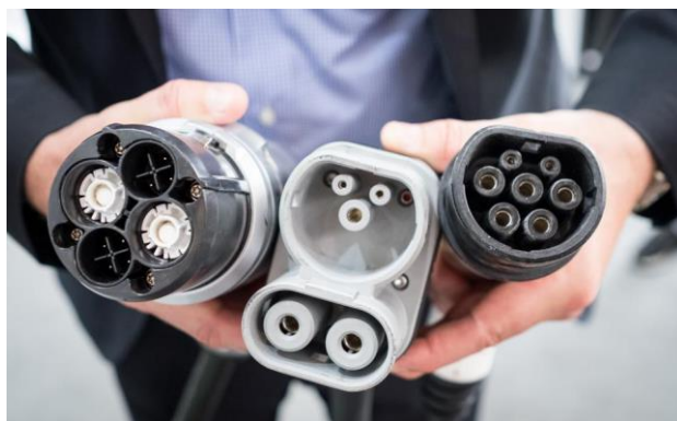
2. ábra: CHAdeMO, CCS és Type2 csatlakozó (balról jobbra).
