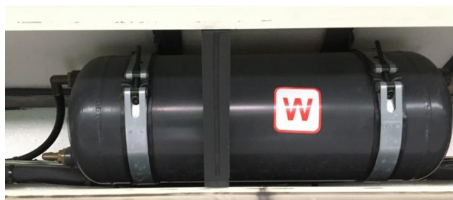
4. ábra: A sűrített levegő tárolására szolgáló tartály.
