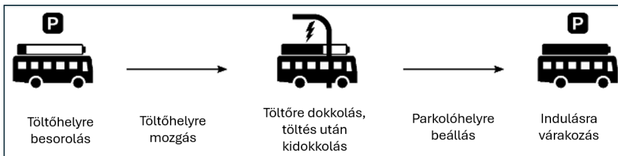
21. ábra Töltési logika alapján vezérelt folyamat sémája Jefferies, 2020, [68]
