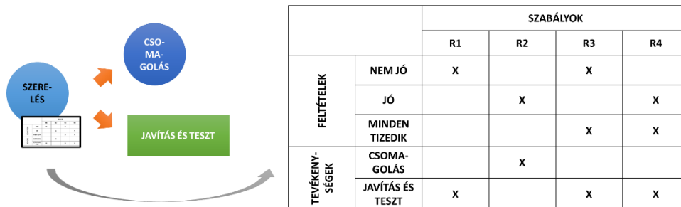
43. ábra Egyszerű gyártási folyamat és döntési táblája
