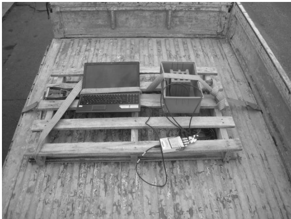
12.Ábra. Rezgésmérés fényképfelvétel, teherautós szállítás
